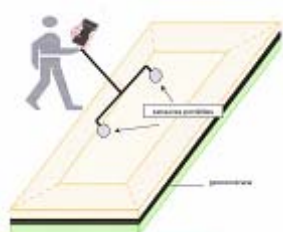
Fig. 20 Esquema del dispositivo de detección, portátil
